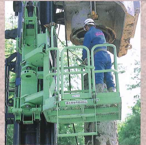
▲LG200T昇降式作業床
